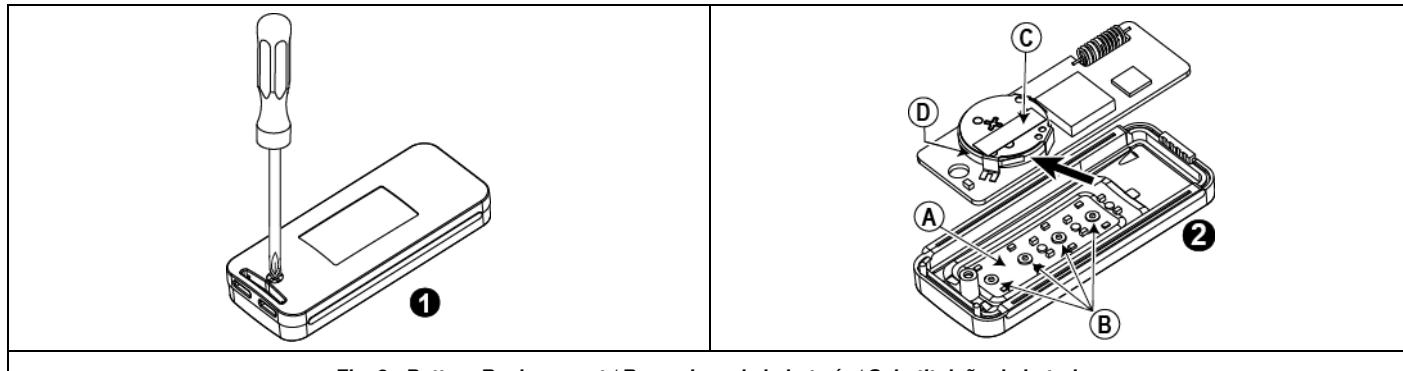
Fig. 2 - Battery Replacement / Reemplazo de la batería / Substituição da bateria
